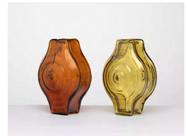
Старинный и современный стеклянный кирпич фальконье модели №8.
